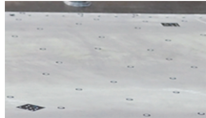
图5 标志点与编码点的布设
